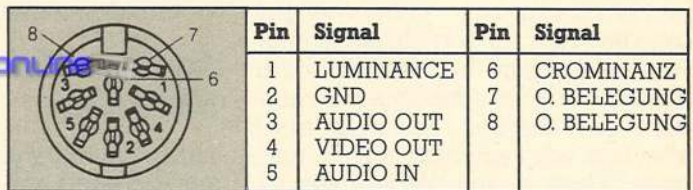
Bild 9. Die Belegung der Video/Audio-Buchse
