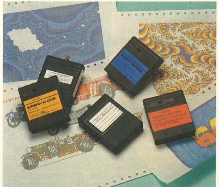
Bild 4. Eine Auswahl an verschiedenen Hardcopy-Modulen viert man die Module, die dann einen Ausdruck zu Papier bringen. Bild 4 zeigt Ihnen, wie solche Module aussehen (Superpic-764, Superpic 2064, Superpic Universal, Picture Printer und das Dela-Hardcopy-Modul).
