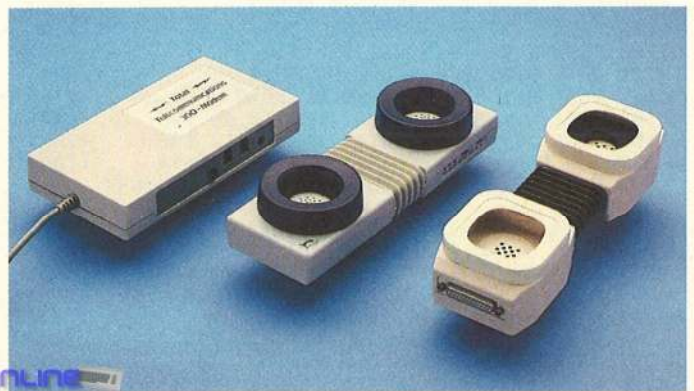
Bild. Die zur DFÜ benötigte Hardwareausstattung: Akustik-Koppler oder Modem
