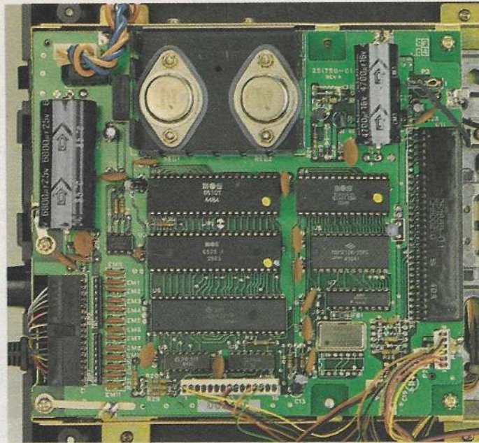
Bild 1. Die Platine der Floppy 1551. In der Mitte sehen Sie die Lötbrücke (JP1).
