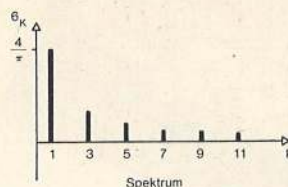
Bild 4. Korrespondenz zwischen Zeit- und Frequenzbereich
