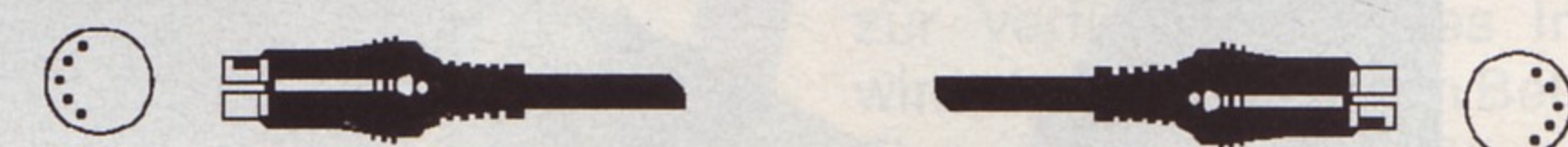
Kabeltyp: fünfpoliger DIN-Stecker an fünfpoligen DIN-Stecker Verwendung: C64/C128 an Stereoanlage
