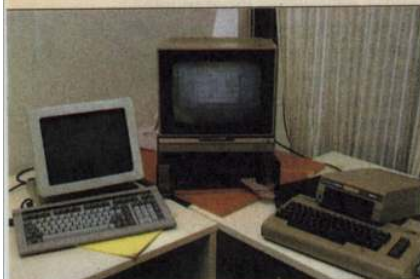
Der typische Arbeitsplatz eines Geos-Entwicklers bei Berkeley Software Works - neben dem UNIX-Terminal steht ein C 64 mit Floppy und ein ICE (In Circuit Emulator)
