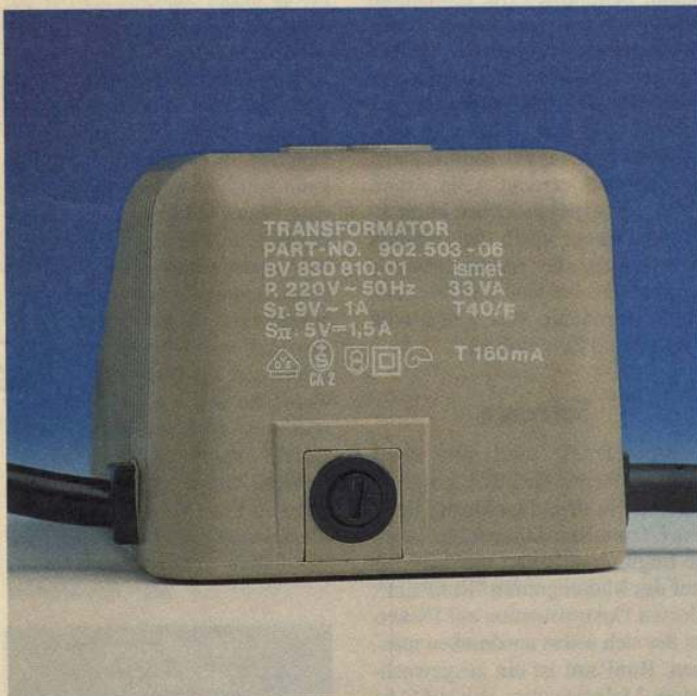
Mit einem Schraubendreher öffnen Sie die Halterung der Sicherung an der Rückseite des Netzteils
