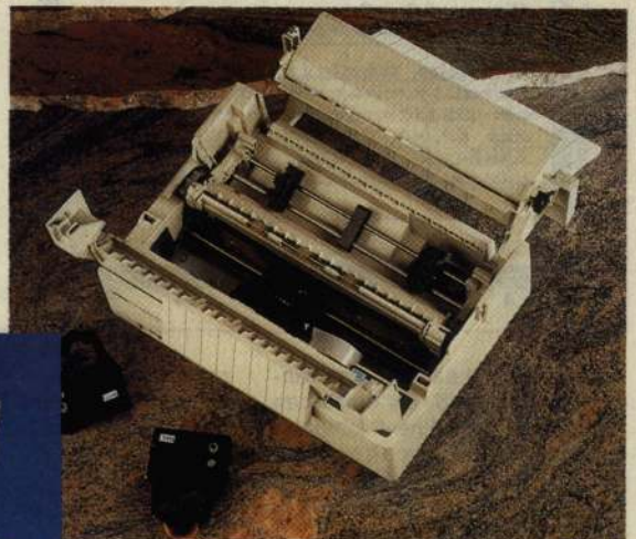
Der LC 24-30 hat ein neuartiges Gehäuse, das eine hohe Geräuschdämpfung bewirkt
