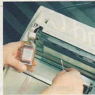
Diese Führungsstange ist mit einem (!) Tropfen Öl zu schmieren
