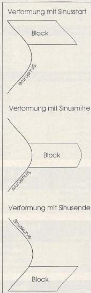
Die drei Möglichkeiten bei der Sinusverformung: Je nach Wahl des Startpunktes, wird der gewählte Blockbereich verzogen. Die Funktion arbeitet in X- und Y-Richtung.
