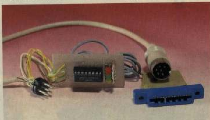
Das fertige Testmodul braucht noch einen 5-Volt-Anschluß vom Cassetten-Port
