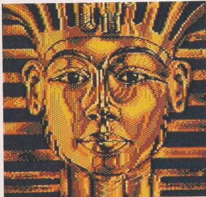
Nicht kleckern, sondern klotzen und zwar mit Farben. Multicolor-Bilder zeichnen sich zwar nicht unbedingt durch hohe Auflösung aus (nur 160 x 200 Bildpunkte im Gegensatz zu 320 x 200 bei HiRes-Bildern), glänzen aber mit sämtlichen 16 Farben des C64.
