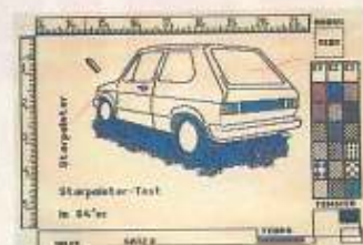
Ein normales HiRes-Bild mit insgesamt zwei Farben eignet sich ideal für technische Zeichnungen
