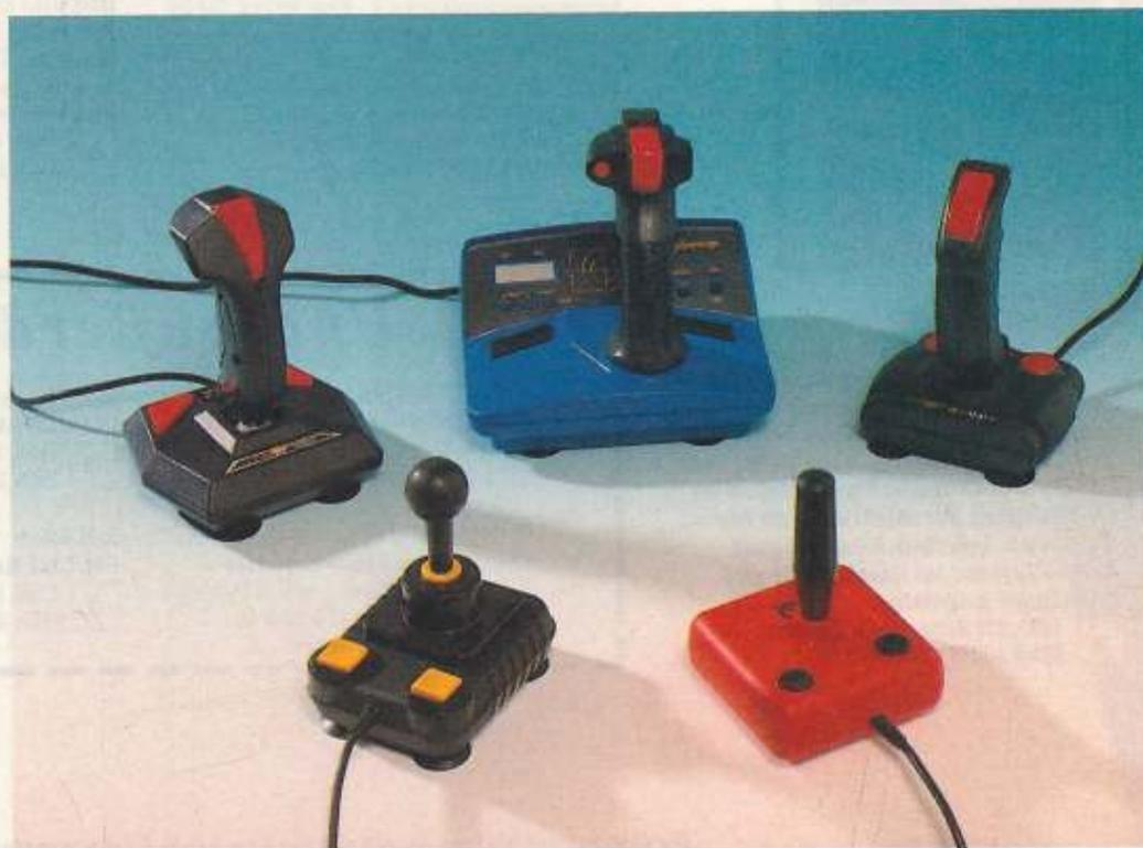
Die fünf Testmodelle aus England: »Star Probe« von Cheetah, »Gamma Ray« von Logic 3, »Cheetah 125+« (hintere Reihe v.l.n.r.), »Zip Stik« von Sonmax, »Q Stick« von Suncom (vordere Reihe v.l.n.r.)
