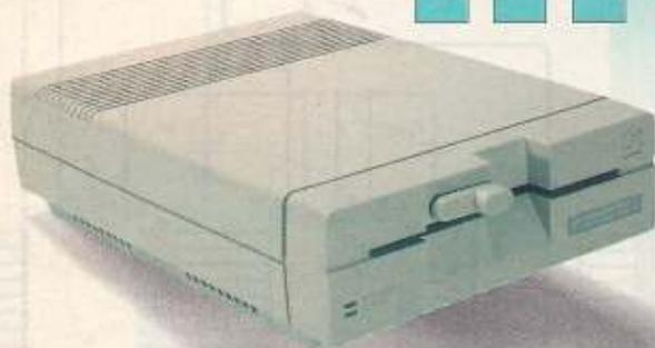
*Das Innenleben der Floppy besteht aus einem eigenständigen Computer, der als Gehilfe des C 64 fungiert. Über den seriellen Bus kann der Computer mit dem C 64 kommunizieren.*
