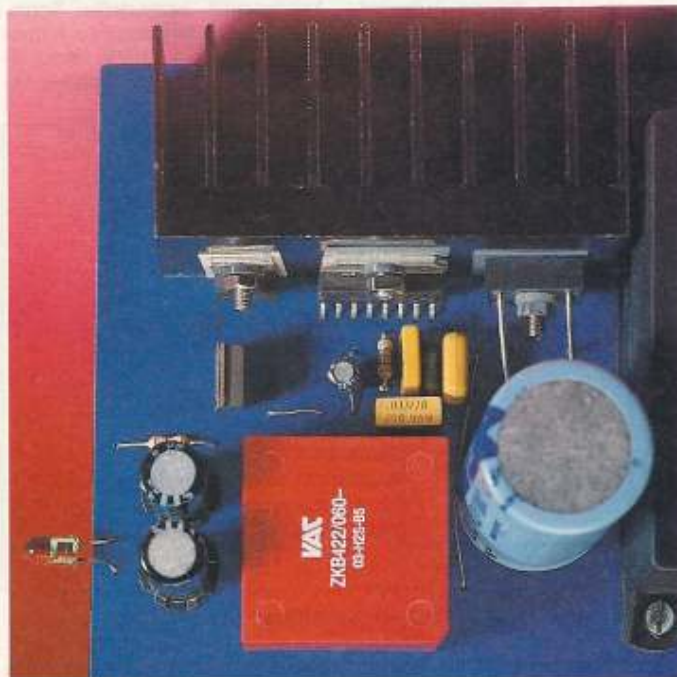
B Achten Sie auf die isolierte Befestigung der Halbleiter am Kühlblech
