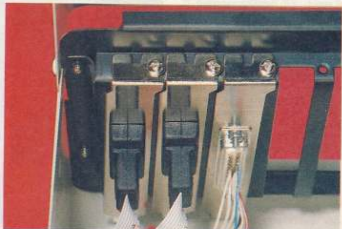
12 Die Joystick-Parts und das Tastaturkabel werden zur Rückseite geführt
