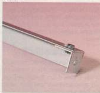
1 Zwischenträger wird aus einem Aluwinkel gefertigt
