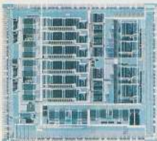
Das Innere des neuen Signalprozessors DSP LH 9124
