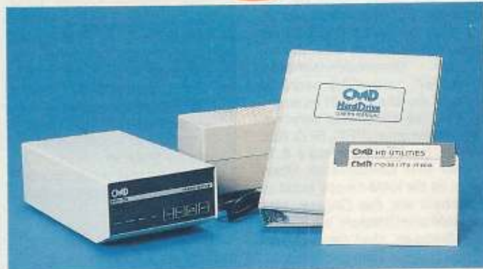
Die 20-MByte-Festplatte »HD 20« von CMD
