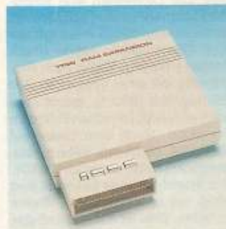
Commodore-RAM-Erweiterung mit bis zu 2 MByte
