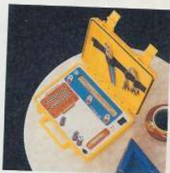
Der »Data Blue Industrial« zum Testen von RS-232-, 422/423-, 485-, Centronics- und Current-Loop-Schnittstellen
