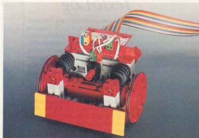
3 Die Schildkröte ist über ein Flachkabel mit dem C64 verbunden und erhält durch ihn eine gewisse Intelligenz
