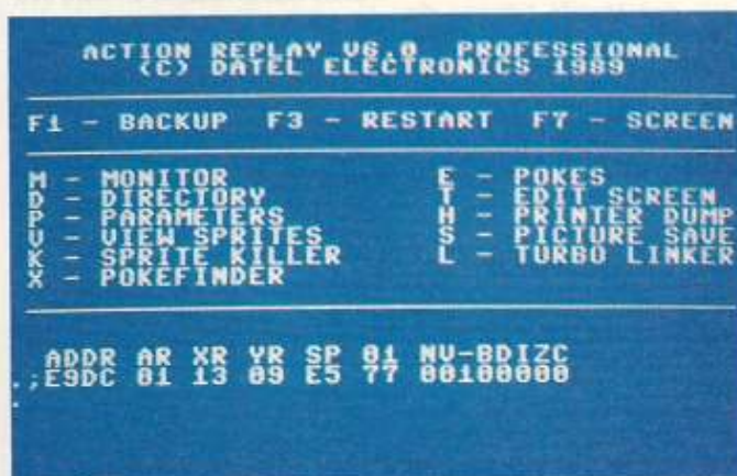
5 Der Monitor der Action Replay gibt Einblick in den Speicher
