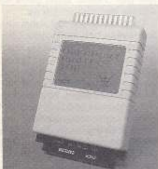
1 Schutz für die CIA mal ganz ohne Waffen. Einfach, aber wirkungsvoll: der User-Port-Protector.
