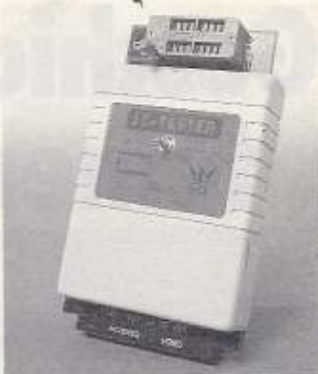
4 C64 als TTL-IC Prüfgerät mit dem IC-Tester
