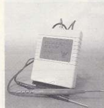
2 Die Messung von Frequenzen bis fast 100 MHz ist mit dem Frequenzmesser kein Problem mehr
