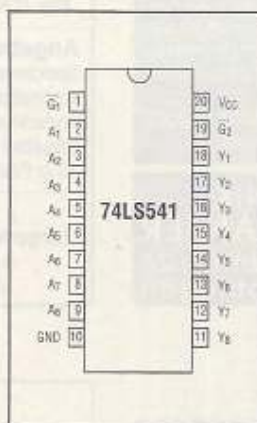
2 Das Anschlußbild des Leitungstreibers 74 LS 541. Er beinhaltet 8 unidirektionale Bustreiber.
