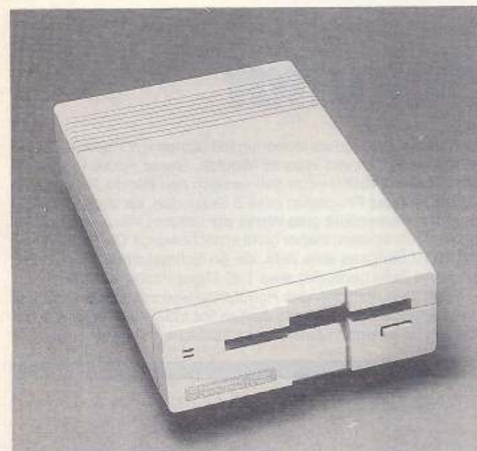
2 Mit der 1581 in die Zukunft: Auf 3 1/2-Zoll-Disketten werden 790 KByte gespeichert.
