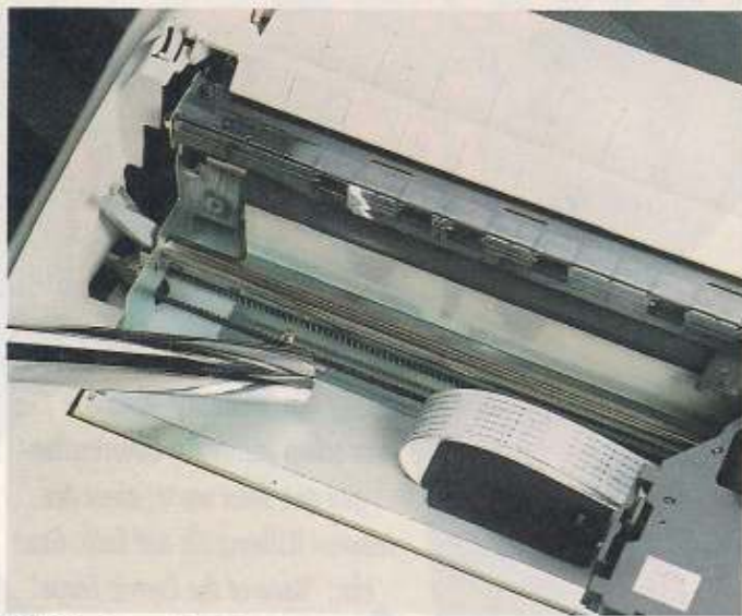
1 Mit einem Staubsauger kann man den Schmutz aus dem Druckraum hervorragend entfernen
