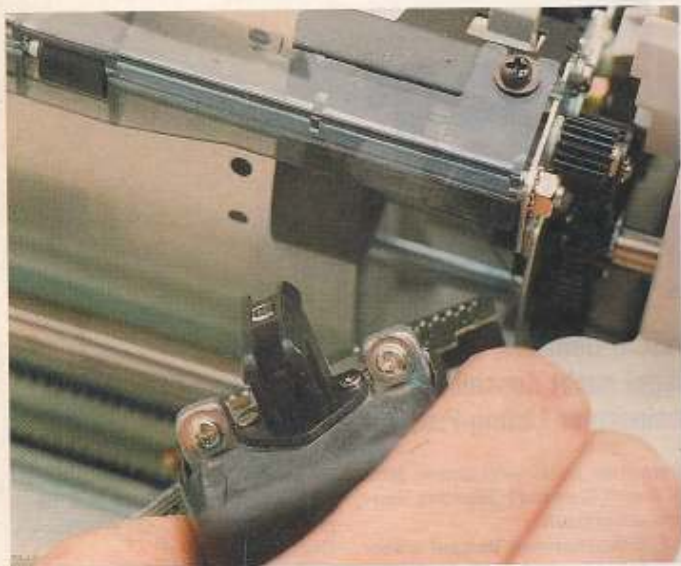
5 Suchen Sie sich eine sichere Stelle, an der Sie den Druckkopf halten können, ohne vom Wagen getroffen zu werden
