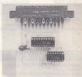
4 Diese einfache Schaltung schützt die CIA im User-Port
