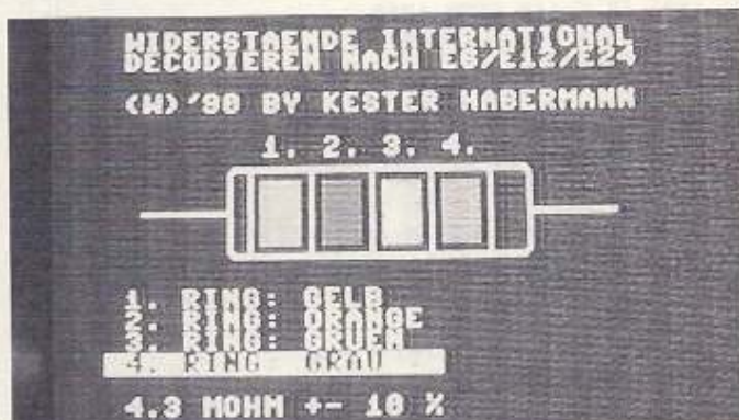
Widerstandsfarbcode schnell dekodiert
