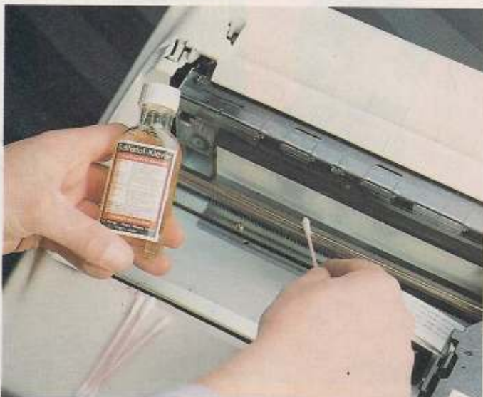
2 Beim Einölen der Führungsschienen muß man besonders vorsichtig sein. Als Öl eignet sich Ballistol.
