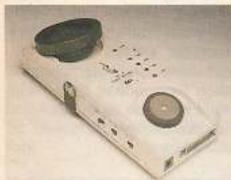
Der »Adam 2412« ist Modem und Akustikkoppler in einem
