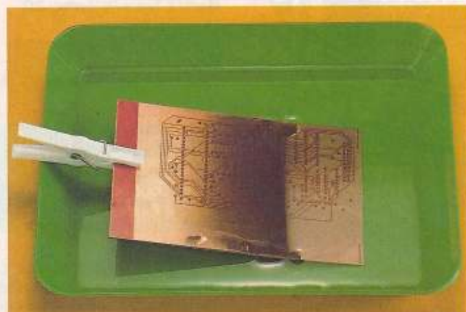
5 Das Entwicklungsbad durch leichtes Schwenken in Bewegung halten. Nur so löst sich der Fotolack gleichmäßig.
