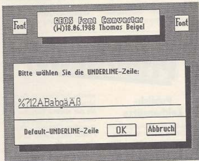
4 Der Zeichensatz »Paktolos 13« wird gerade konvertiert. Der »Font-Konverter« erwartet dazu unter anderem die Angabe der Höhe, in der unterstrichen werden soll.
