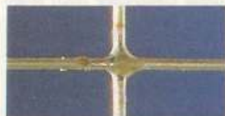
3 So sieht eine richtige Lötstelle aus
