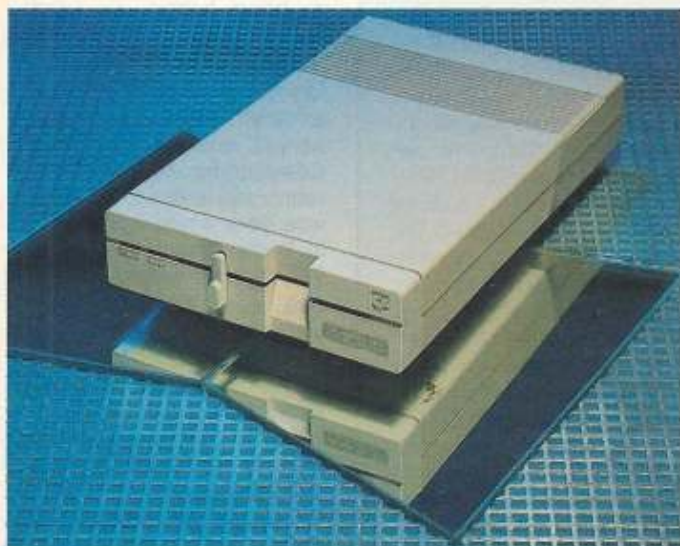
3 Das Diskettenlaufwerk 1571 kann Disketten beidseitig nutzen – egal, was mancher Verkäufer einem hierzu auch sagen mag ...
