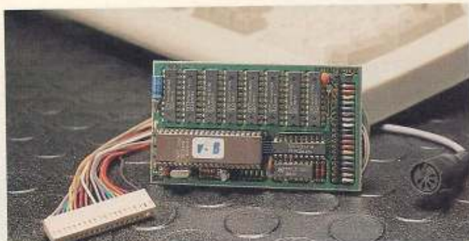
Mit dem Interface von Elve EDV soll sich jede AT-Tastatur an den C64 anschließen lassen
