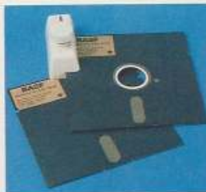
1 Mit einem speziellen Diskettenlocher gelochte Disketten können beidseitig genutzt werden
