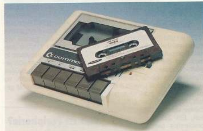
1 Die Datasette sieht einem herkömmlichen Walkman nicht nur ähnlich, sie besitzt auch gleiche Funktionen. Statt Musik nimmt sie jedoch Daten auf.
