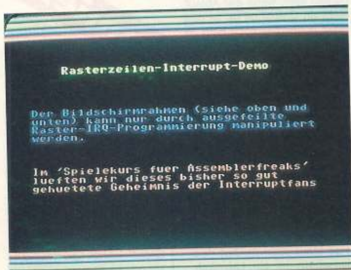
1 Durch Programmierung des Rasterzeilen-Interrupts lassen sich derartige Effekte im Bildschirmrahmen erzielen
