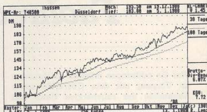
2 Auf Epson-Druckern erzeugt RL-Chart hervorragende Chart-Grafiken. Die Matrix beträgt 640 x 200 Punkte bei einer Auflösung von 120 x 144 dpi.
