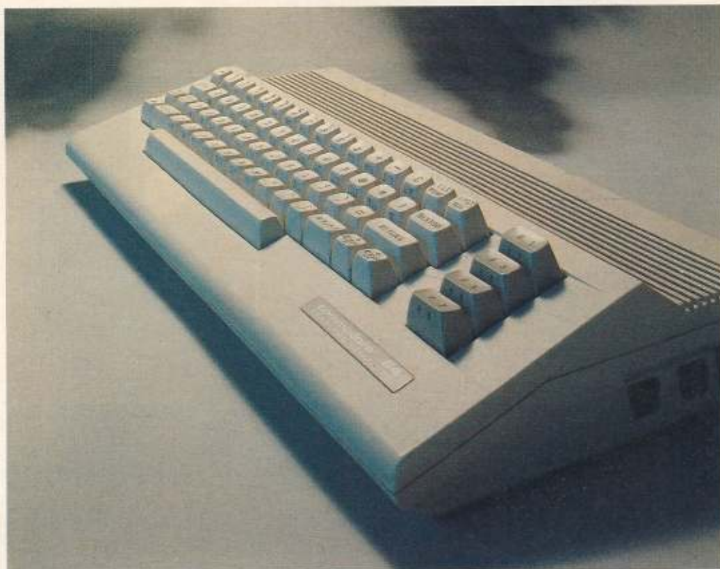
5 Der C64 im neu durchgestylten, flachen Gehäuse. Für interne Hardware-Erweiterungen reichte der Platz meist nicht mehr. Für viele ein Grund sich für die alte Brotkastenform zu entscheiden.
