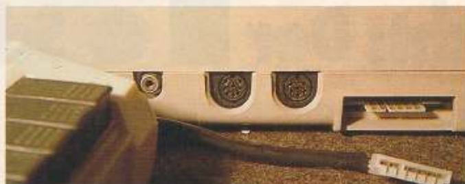
7 Stecker und Anschluß der Datasette an den C 64
