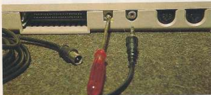
4 Der Fernsehanschluß am Computer. Daneben die Kanaleinstellschraube.
