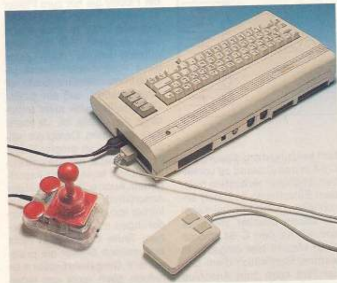
3 Der Joystick Competition Pro (links) hat sich bei unseren Vergleichstests als bestes Gerät erwiesen. Die Maus VC 1351 (rechts) ist besonders geeignet für das Zeichnen »frei Hand«.
