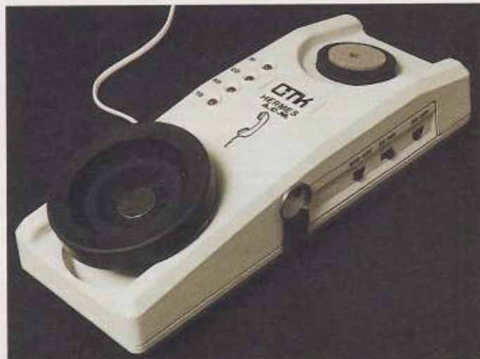
Ein Mittelding zwischen Akustikkoppler und Modem: der CTK Hermes WCM, auch »World-Coupler-Modem« genannt.
