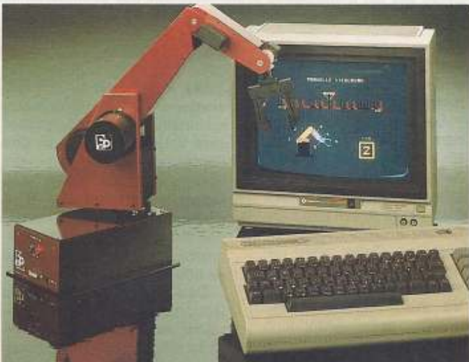
Der »Rob 2« von P+P Elektronik ist ein 5-Achsen-Roboter, der direkt an den User-Port des C 64 anschließbar ist
