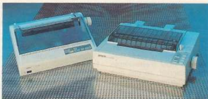
12 Der Star LC-10 ist ein moderner Drucker mit neun Nadeln, der sich in der Centronics-Version leicht am User-Port anschließen läßt. Der Epson LQ-850 ist ein wahrer Alleskönner. Er druckt mit 24 Nadeln perfekte Schrift und Grafik – der Anschluß am User-Port des C64 ist kein Problem.
