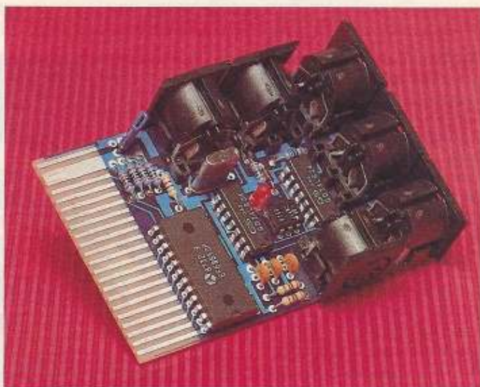
Das neue C 64-Midi-Interface von Roßmüller
