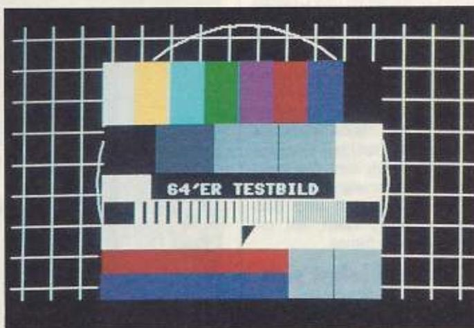
**6** Durch die Sony-Black-Matrix-Trinitron-Röhre und eine Bandbreite von 21 MHz hat der Sony Color-Monitor ein Spitzenbild. Allerdings ist die Bildröhre mit 10 Zoll etwas klein.
