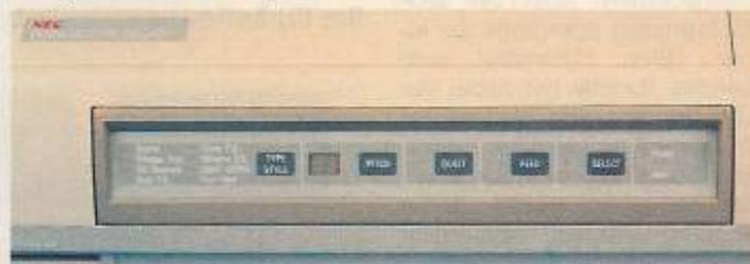
**Das Bedienfeld des NEC glänzt mit einem eigenen LED-Display für Schriftenanzeige und Fehlermeldungen**
