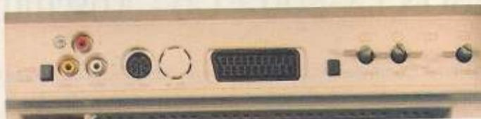
6 Die Rückseite des 1084 ist mit der des KP748 fast identisch. Hinzugekommen ist eine zusätzliche Schnittstelle, der Eingang für das getrennte FBAS-Signale.
