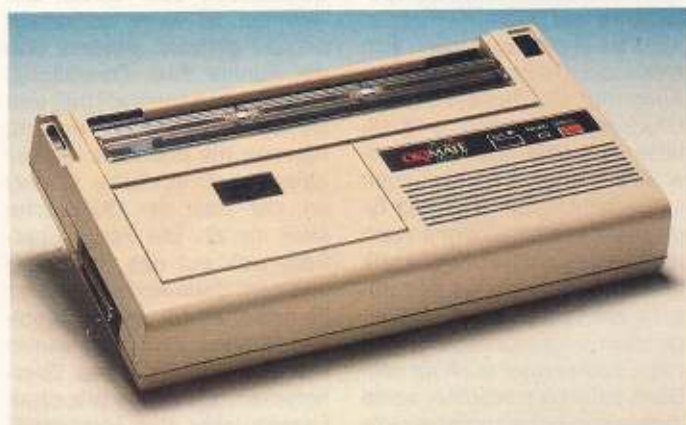
Der Okimate 20 ist ein sehr preiswerter Thermodrucker, der sogar farbig drucken kann
