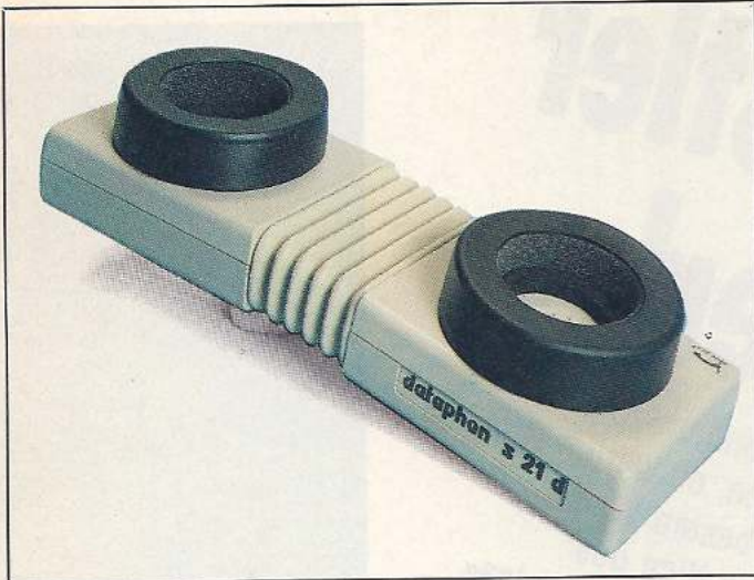
Mit einem Akustikkoppler erschließt sich auch für den C 64-Anwender die Welt der DFÜ
