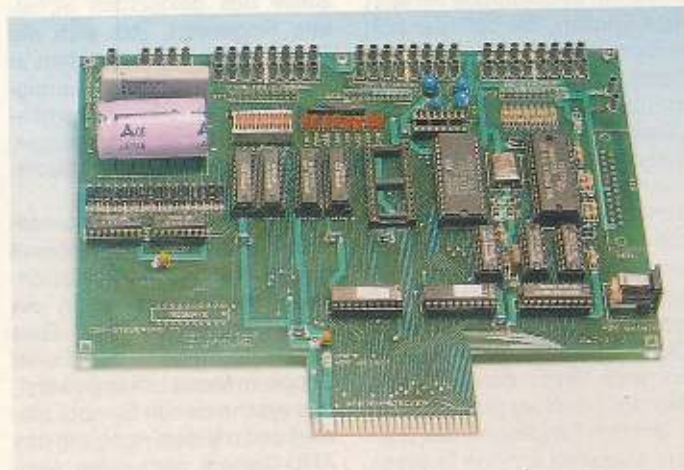
1 Mit dem Logik-Simulator lassen sich TTL-Schaltungen auf dem Computer entwickeln und testen
