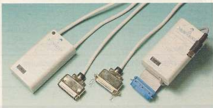
Printerinterface (rechts) und Bitmaster (links) sorgen für korrekten Anschluß eines 24-Nadel-Druckers an den C64 und C128
