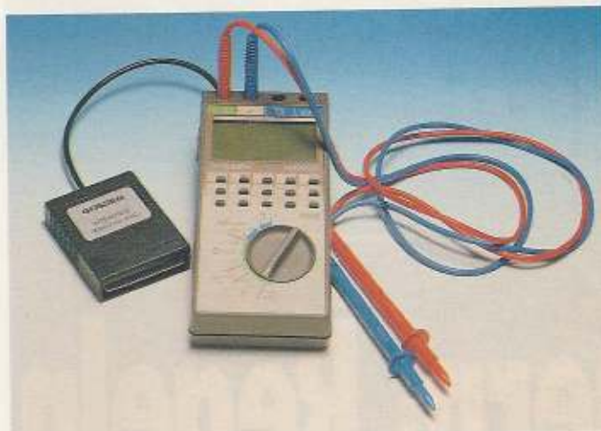
3 Das Vielfachmeßinstrument Mavo 40 kann man über ein Interface mit dem C 64 verbinden
