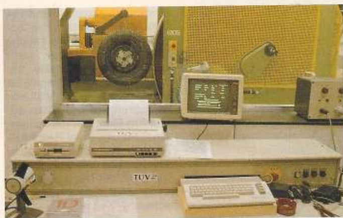
Ein C 64 mit Präsident-Drucker wird beim TÜV Bayern als Meß- und Steuercomputer eingesetzt
