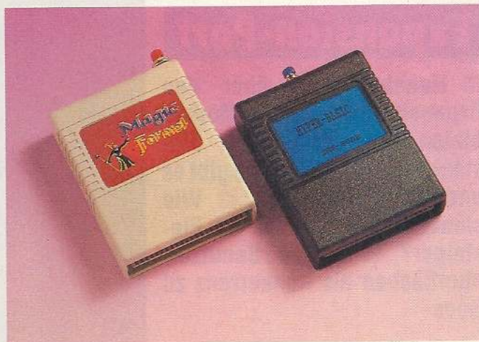
Bild 2. Ein Modul ist im Prinzip eine Speichererweiterung
