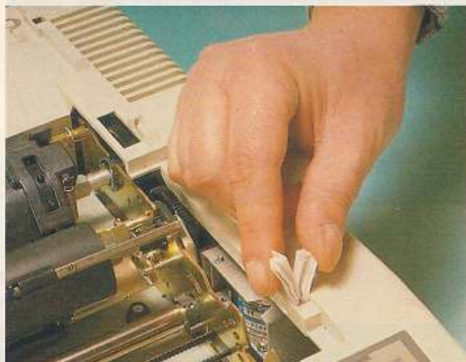
Bild 5. Der Sicherheitsschalter der Abdeckhaube muß überlistet werden
