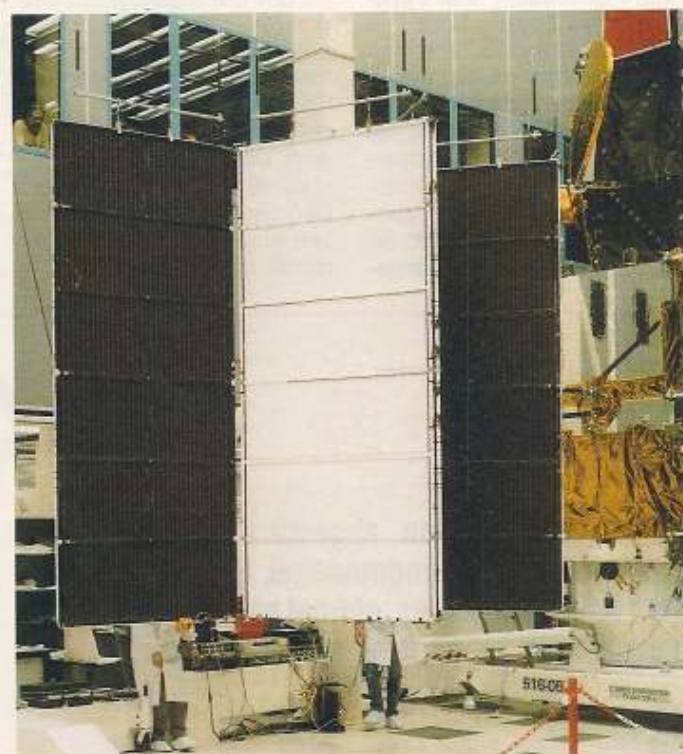
Bild 3. Der Solargenerator des TV-SAT 1 beim Entfalt-Test. Die einzelnen Flügel sind an einem Entfaltssimulator aufgehängt.
