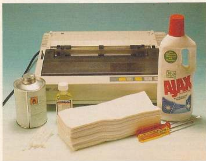
Bild 1. Diese Reinigungsmittel brauchen Sie zum Reinigen Ihres Druckers. Das Ballistol bekommen Sie im Waffengeschäft.
