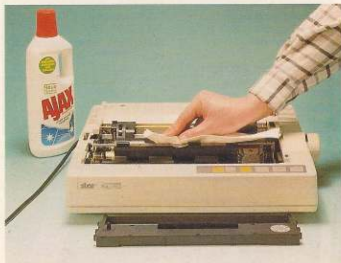
Bild 2. Die Druckwalze wird vorsichtig mit einem Reiniger, ohne daß Flüssigkeit in den Drucker gelangt, abgewischt
