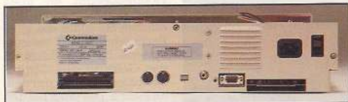
Bild 4. Die Heckpartie des C 128D. Die Buchsen befinden sich jetzt mehr in Bodennähe, und der Anschluß der Datasette wurde von der Gehäuserückseite verbannt.
