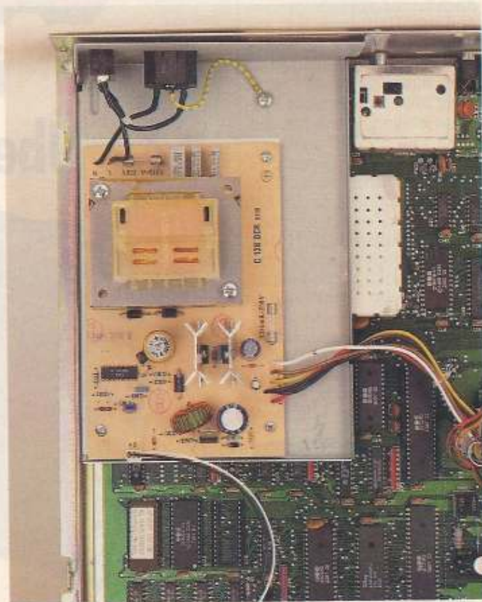
Bild 3. Das »nackte« Netzteil des neuen C 128D im Detail
