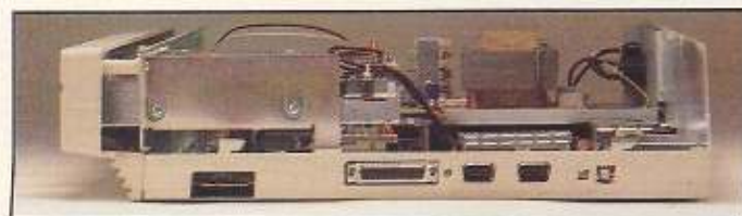
Bild 5. An der Gehäusesseite hat sich wenig getan. Lediglich der Anschluß für die Datasette ist neu hinzugekommen.
