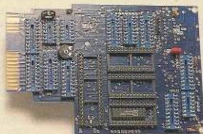
nun sauber in einem Sockel. Die übrigen Widerstände wurden entgegen der Bauanleitung nicht stehend, sondern zweckmäßigerweise liegend bestückt. Dies ist in einigen Fällen wegen der IC-Sockel etwas umständlich. Bei der Bestückung der Elkos mußte bei dem am Rande liegenden schwarzen Kondensator etwas nachgeholfen werden, da dieser für die Platine zu groß geraten ist. Dagegen ging das Einlöten der beiden Transistoren leicht von der Hand.
