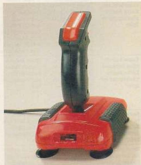
**Bild 5.** Der »Quickshot II« kann trotz alter Technik mit modernen Joysticks konkurrieren, verschleißt jedoch schneller. Hier die exklusive Version »Quickshot II Turbo«.
