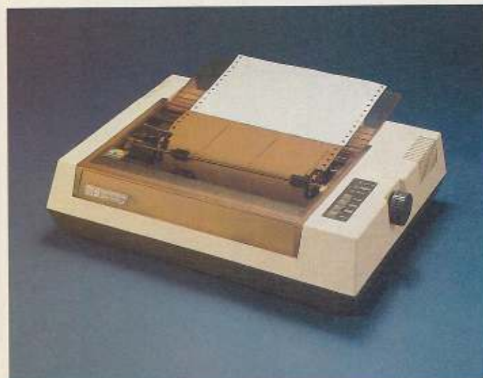
Bild 2. Der Seikosha GP 700 ist sogar ein Farbdrucker für farbige Hardcopies und Text. Sein Befehlssatz ist allerdings etwas problematisch, weil inkompatibel zum Industriestandard.
