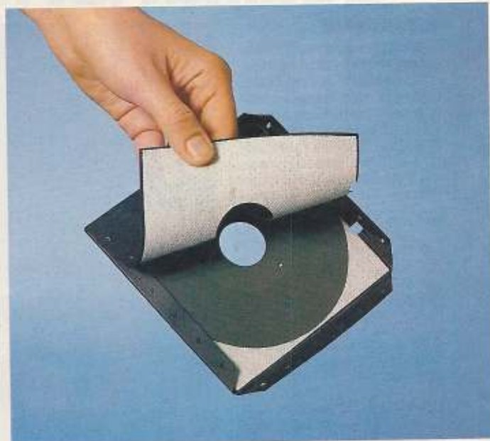
Bild 2. Die »Innereien« einer Diskette besteht aus eine Magnetscheibe, auf der die Daten gespeichert werden. Die weiße Schicht verhindert ein Zerkratzen der drehenden Scheibe.
