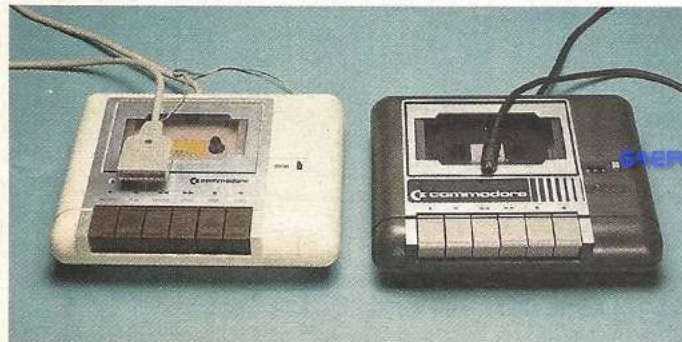
Bild 2. Die Datasette, als primitiver aber preiswerter Massenspeicher für die Heimcomputer von Commodore
