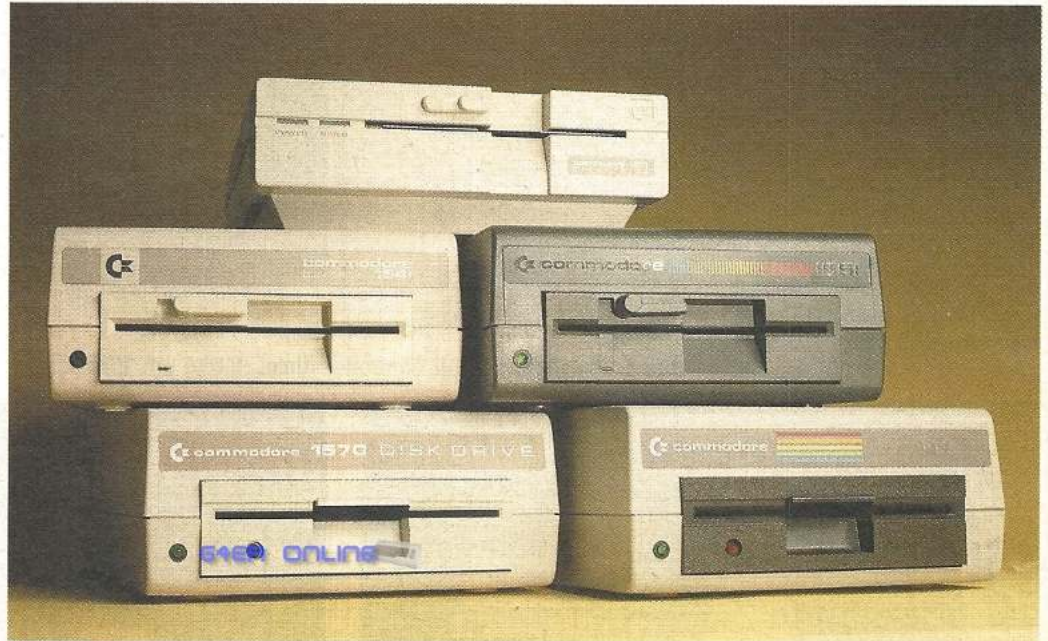
Bild 7. Die Floppy-Stationen der Commodore-Heimcomputer. Bis auf die 1571 (ganz oben) arbeiten sie einseitig und verfügen über zirka 170 KByte (1571: 340 KByte) Speicherkapazität.
