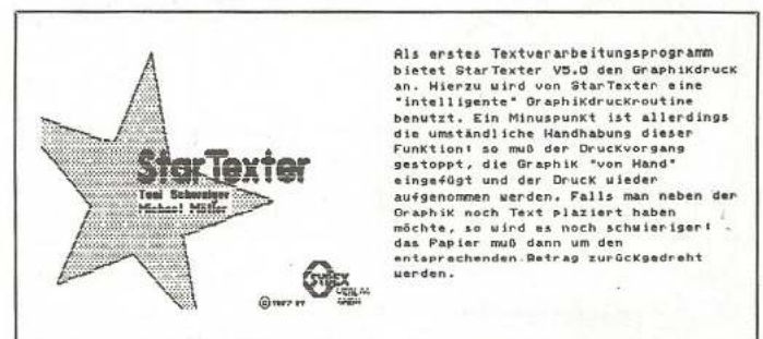
Bild 2. Text und Grafiken mischen funktioniert — leider muß das Papier von Hand zurückgedreht werden
