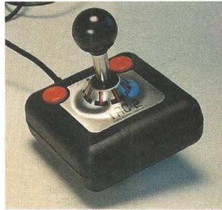
Bild 12. Der Joystick mit den Kugelkontakten: Tac 2
