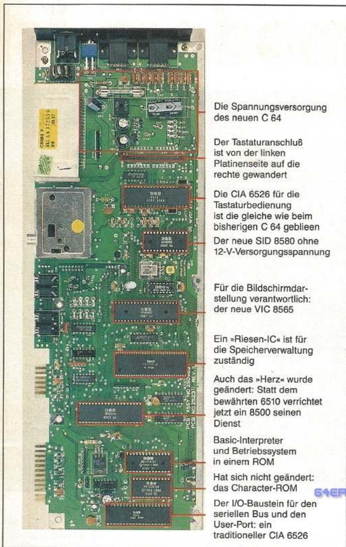
Bild 2. Hardware-technisch hat sich einiges geändert. Viele neue Chips lösen die veraltete Elektronik des bisherigen C 64 ab.
