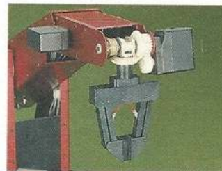
Bild 9(+9a). Der »ROB 2« ist mit sechs Freiheitsgraden der gelenkigste unter den C 64-Robotern. Im Detail unten ist das Getriebe zum Schwenken und Drehen des Greifers zu sehen.
