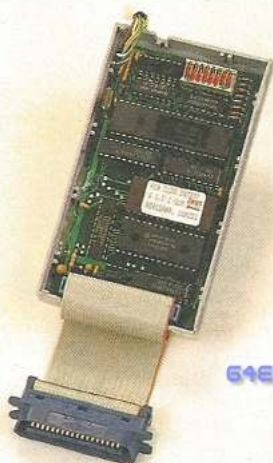
Bild 3. Interfaces dienen der Anpassung von Daten an andere Geräte. Hier ein Druckerinterface.
