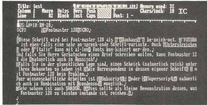
Bild 1. Der Statusbereich bietet eine Fülle von Informationen, durch Steuerzeichen wird der Text auch leicht unübersichtlich
