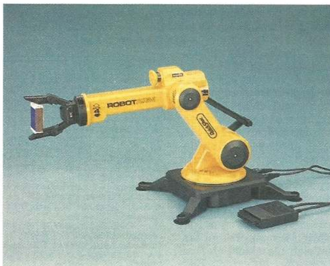
Bild 8. Der batteriebetriebene Roboter von Conrad Electronic hat fünf Freiheitsgrade
