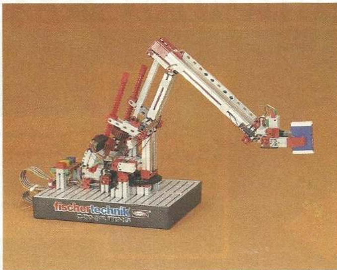
Bild 6(+6a). Beim »Trainingsroboter« sind Spindeltrieb und Gabellichtschranken deutlich zu erkennen (unten)
