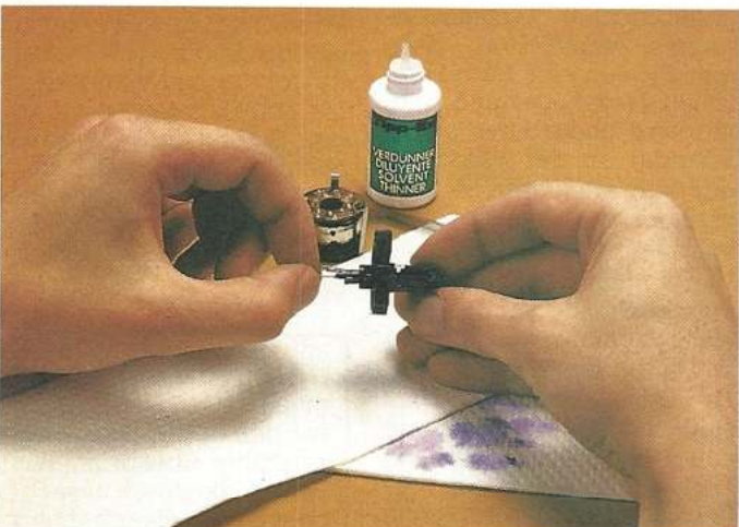
Bild 7. Beim Einsetzen der Nadeln darf keine Gewalt angewendet werden, da diese verbogen werden könnten
