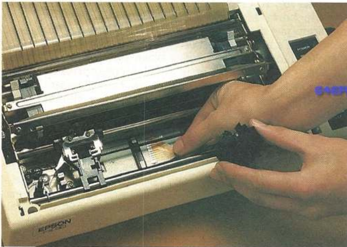
Bild 3. Ziehen Sie das flexible Verbindungskabel vorsichtig aus der Verbindungsleiste an der Unterseite des Schachtes
