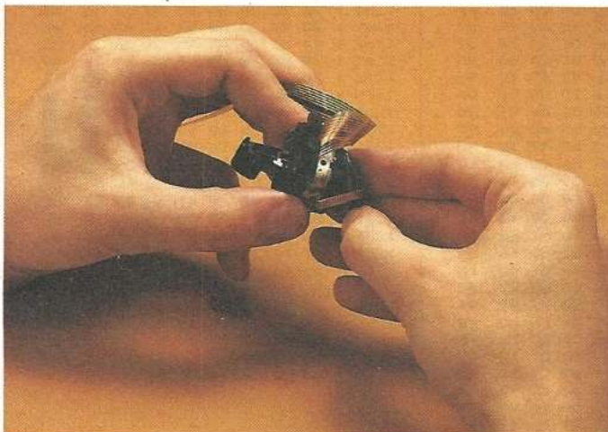
Bild 5. Öffnen der Klammern, die das Innenteil zusammenhalten. Das Führungsplättchen sollte mit Farbe markiert werden
