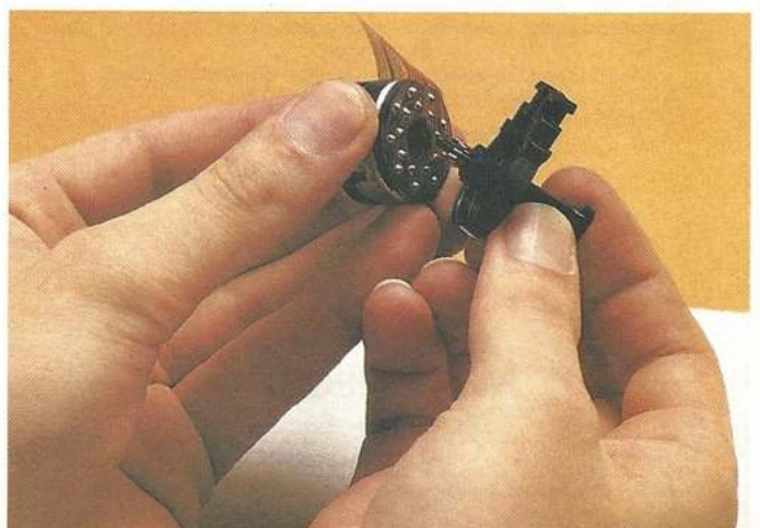
Bild 8. Zum Abschluß ist das Innenteil wieder mit der Klammer zu verbinden und in den Kühlkörper einzudrücken
