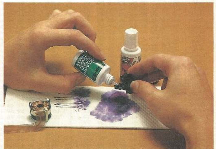
Bild 6. Die Nadeln und das vordere Kopfteil wird mit Tipp-Ex-Verdüner oder Isopropyl-Alkohol von den Farbrückständen gesäubert
