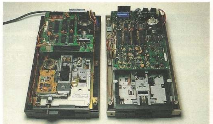
Bild 2. So sieht die 1551 (links) und die 1541 geöffnet aus. Deutlich ist der Unterschied zwischen beiden Platinen zu erkennen.
