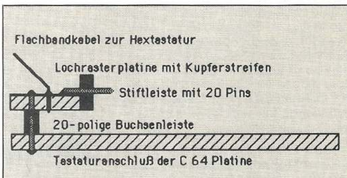
Bild 2. Querschnitt (längs einer Leiterbahn) des Adaptersteckers
