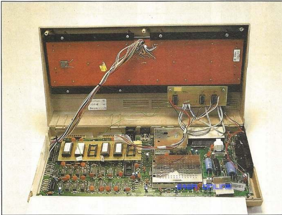
Bild 6. So wird EPROM-Trans in den C 64 eingebaut
