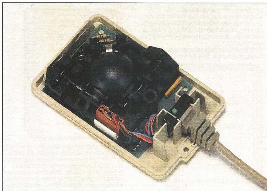
Bild 7. Die Mechanik und die Elektronik einer Maus ist identisch mit der eines Trackballs
