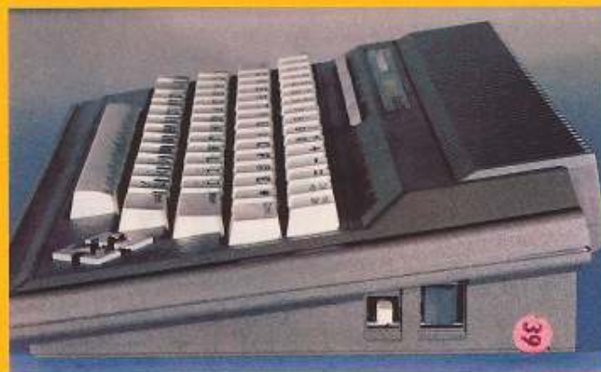
Bild 4. Neben dem Netzschalter ist ein Resetknopf angebracht
