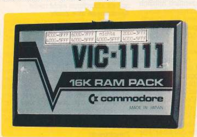
Bild 1. 16-KByte-Erweiterung mit eingebautem Umschalter
