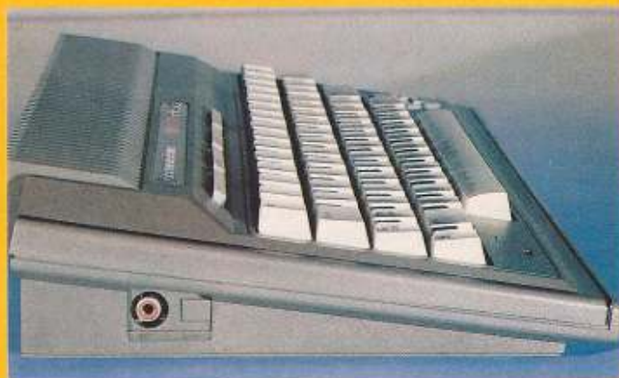
Bild 6. Der HF-Ausgang ist an der Seite angebracht. Der zweite abgedeckte Ausgang ist in der amerikanischen Version ein Kanal-Umschalter.
