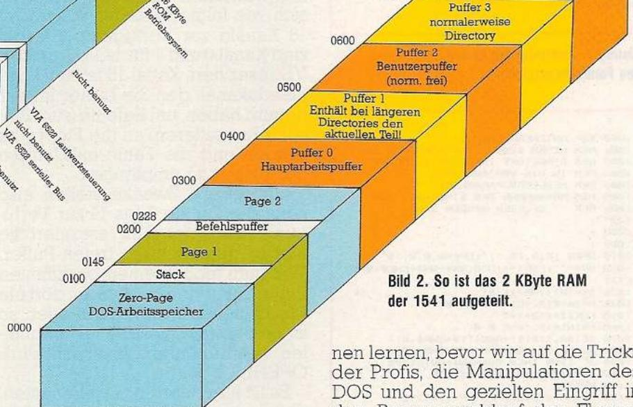
Bild 2. So ist das 2 KByte RAM der 1541 aufgeteilt.
