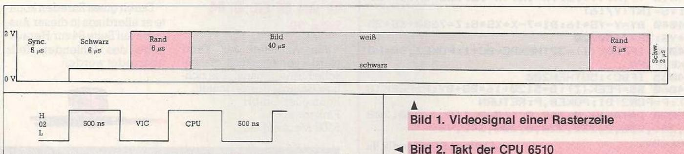
▲ Bild 1. Videosignal einer Rasterzeile
