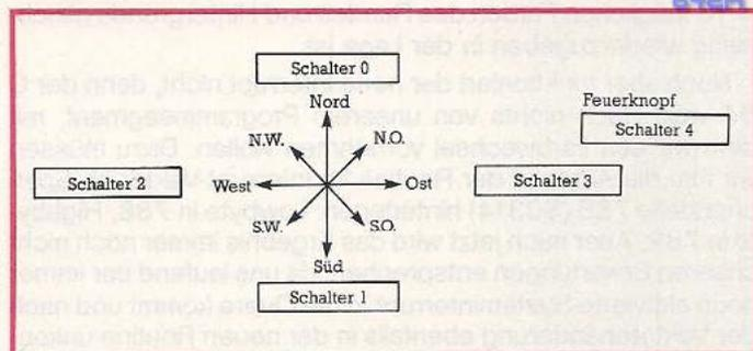
Jeder der fünf Schalter ist mit je einer Leitung von zwei speziellen integrierten Bausteinen mit dem Namen »VIA 6522« (Versatile Interface Adapter) verbunden. Diese sind, wie der Name andeutet, programmierbare Adapter für die Ein- und Ausgabe (also auch für den Joystick).
