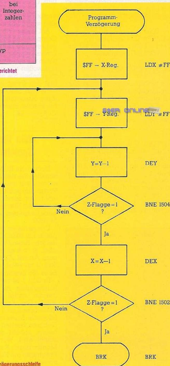
Bild 3. Flußdiagramm zur Verzögerungsschleife
