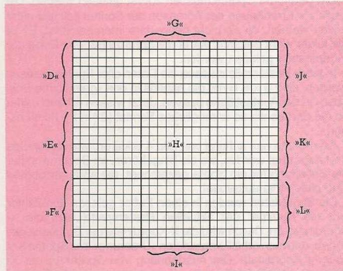
Bild 2. Die Undefinier-Matrix hat 24 x 24 Punkte und ist notwendig, um Sprites auch punktwise verschieben zu können
