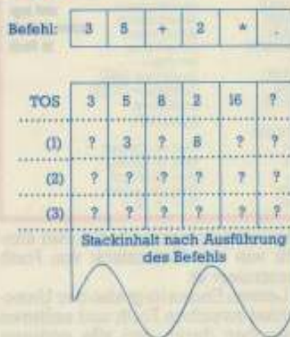
Bild 1. Die Stapelveränderungen während der Ausführung einer einfachen Befehlsfolge. Die Operationen »+« und »*« verknüpfen jeweils die beiden obersten Elemente des Stacks miteinander und legen das Ergebnis wieder ab. Mit ».« wird der TOS ausgedruckt und steht danach nicht mehr zur Verfügung.
