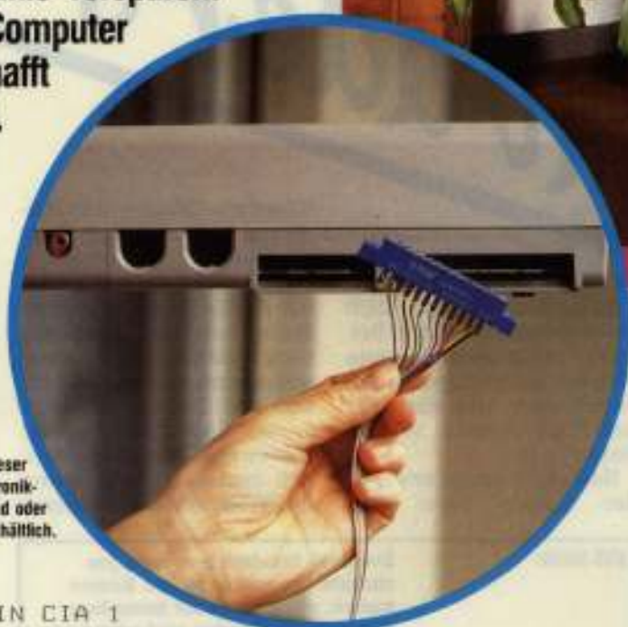
Bild 2. Pinbelegung des User-Ports. Benötigt wurden nur die Anschlüsse 2, A und C.
