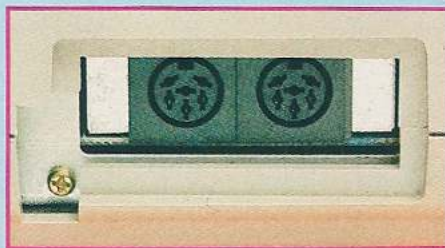
Bild 3. Serielle Schnittstelle, beim VC 1526 und MPS 801 in doppelter Ausführung
