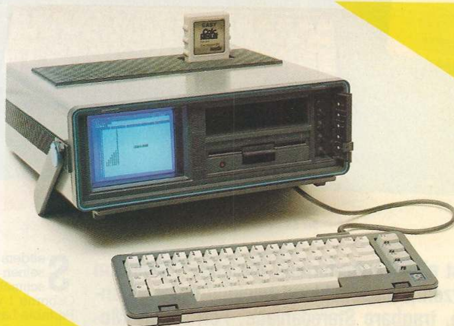
Bild 9. Die Module kommen oben in den Steckschacht
