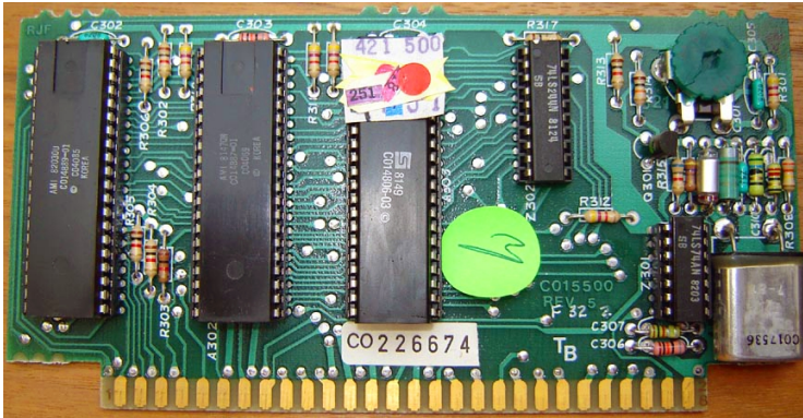
Abb. 4.12: Foto CPU-Board 800 (PAL) mit CPU 'SALLY'
