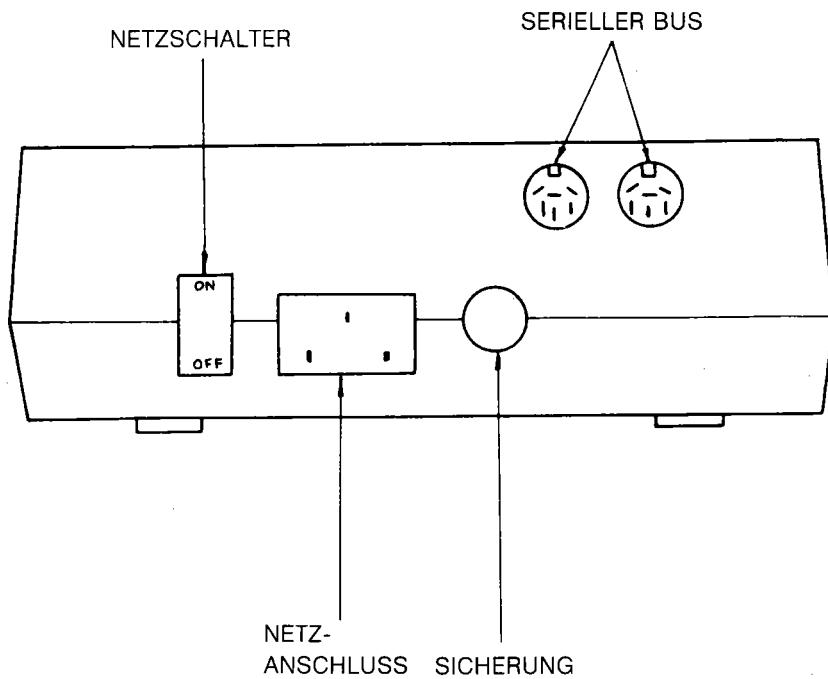
9. Nehmen Sie nun das andere Ende des Verbindungskabels, und stecken Sie es in eine der beiden, in der Illustration mit "SERIELLER BUS" bezeichneten Buchsen.
