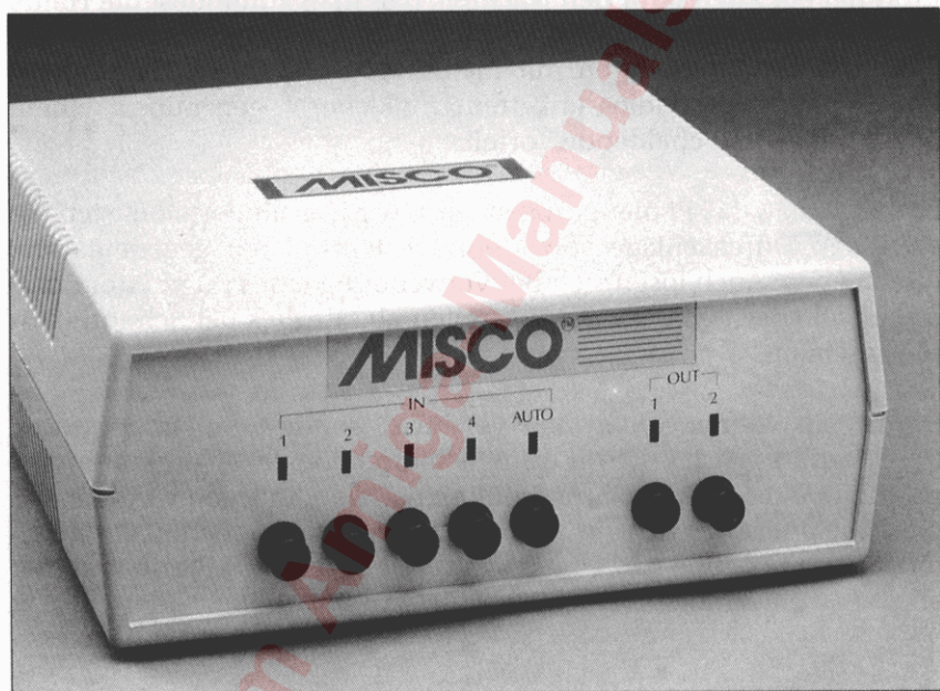
Abb. 9.4: 4 Eingänge (Computer) und 2 Ausgänge (Drucker) können mit dem Misco-Autoswitch geschaltet werden.
